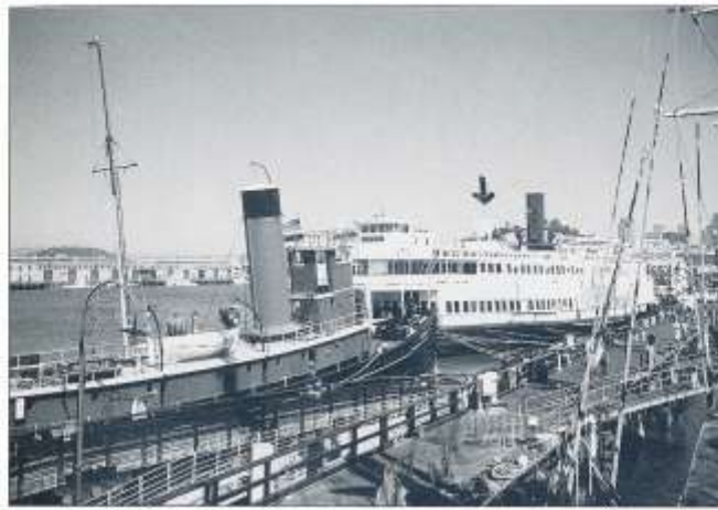
Ångbogsaren HERCULES och ångfärjan EUREKA. Pilen pekar på EUREKAs fackverksbyggda balans som överför vriden från kolostängen till vevstaken. Foto Ove Iho 1998.
