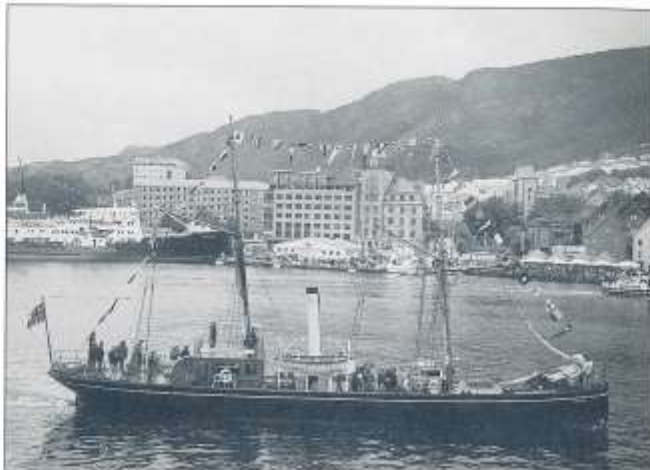
HANSTEEN byggdes 1867 som sjömättningsfartyg och förvägs med både segel och ångmaskin. Fartyget såldes av staten 1897 för att bli last- och passagerångare. Mellan 1916 och 1952 gick ångaren på den utåtta Helgolandskanten. HANSTEEN låg som lagementsfartyg i Oslo när det 1978 övertogs av Stiftelsen D/S Hansteen i Trondheim för att återföras till sitt ursprungliga utseende. Foto Bengt Boman
